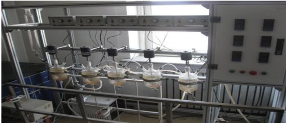
多级燃料油脱硫装置
